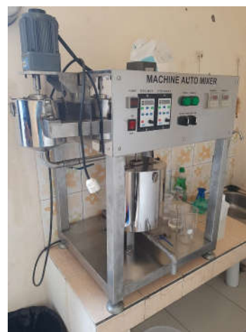
Gambar 2. Homogenizer yang Digunakan untuk Riset Nano Biopestisida Kapasitas 5 Liter
